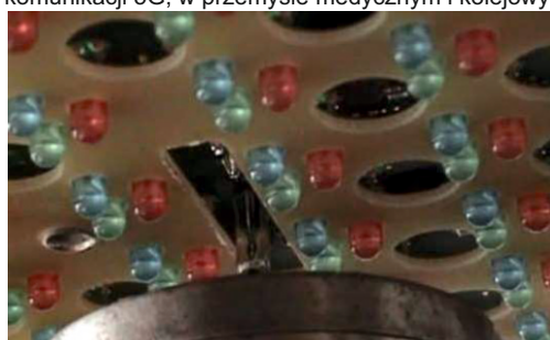
Lutowanie THT płytek PCBA o nieregularnych kształtach, stosowanie w komunikacji, przyrządach testowych i innych zastosowaniach przemysłowych.
