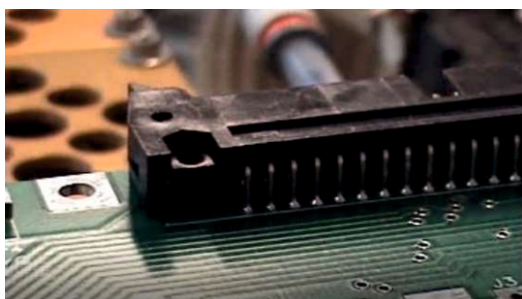
Lutowanie THT złączy, szeroko stosowane w elektronice samochodowej i komunikacji bezprzewodowej
